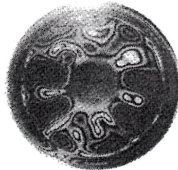
Fig.3: ホログラフィ干渉によるスピーカの振動モードの可視化
